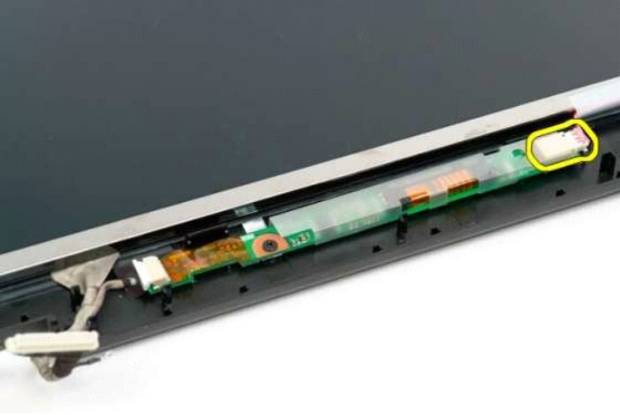
6. Koble datakabelen fra skjermenheten.
